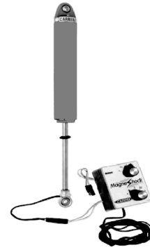
Fig. 2. CARRERA TM MR damper
